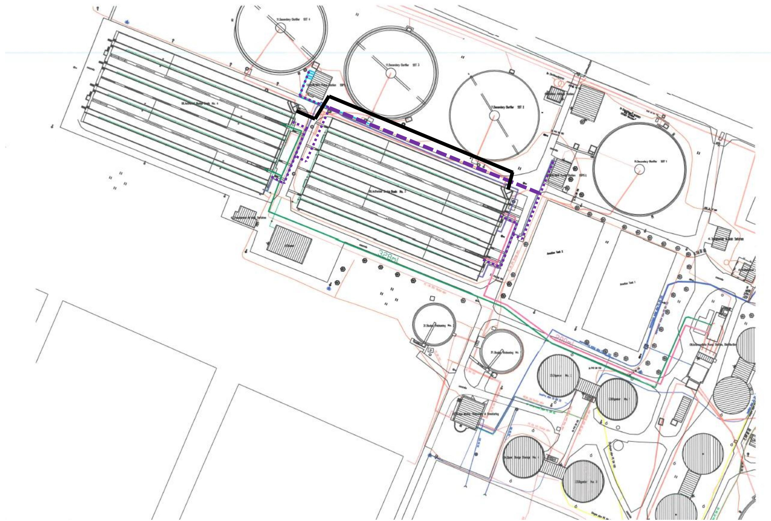
Conducta apa uzata de la statia de pompare la bazine de aerare 1 si 2 (200m, DN1000mm)
